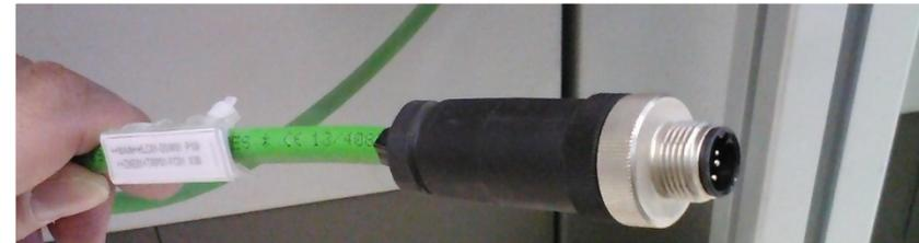
Connettore PROFIBUS infilato a forza in un dispositivo PROFINET.....
