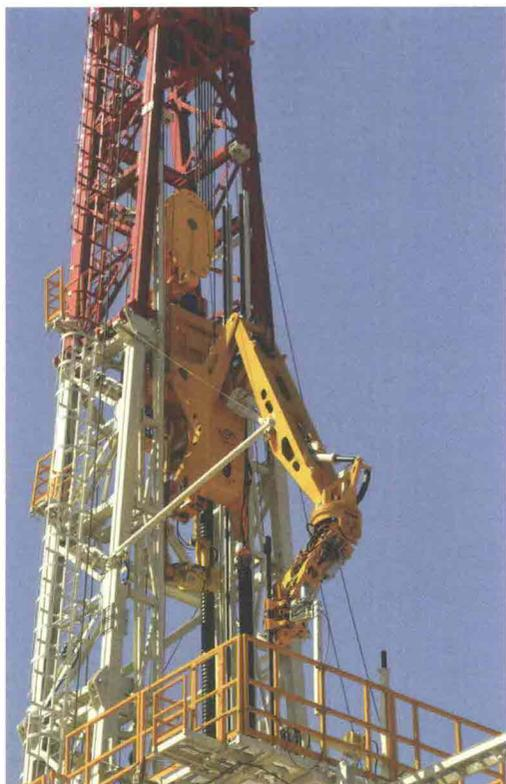
**Stinger è il braccio robotico progettato da Drillmec che opera coordinandosi con il catwalk, mentre la sonda continua a perforare**
