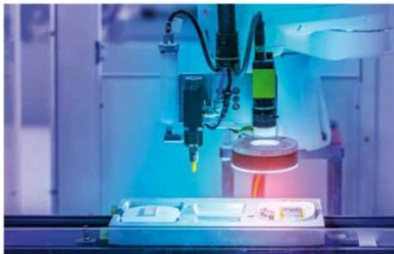
**Sensore di visione e tastatore in un sistema di controllo qualità. Dispositivi di questo tipo trovano in IO-Link il protocollo ideale di comunicazione.**
